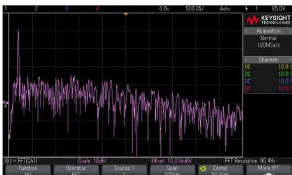
Abb. 3 FFT des Ausgangssignals mit Dithering bei einer Eingangsfrequenz von 4kHz
