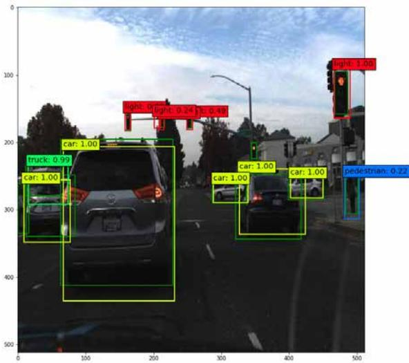
Abb. 1 Detektionen des SSD-7 CNN
