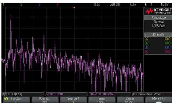
Abb. 2 FFT des Ausgangssignals ohne Dithering bei einer Eingangsfrequenz von 4kHz
