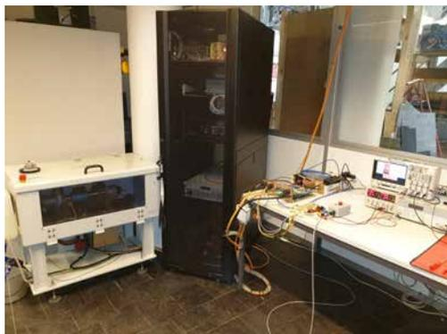
Abb. 2 Der Testaufbau mit Motorenprüfstand links und Inverter sowie Vehicle Control Unit rechts.
