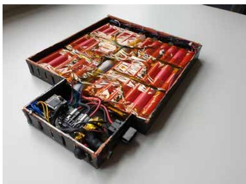
Abb. 3 Der 6S6P Li-Ion Akku für die Fahrzeugelektronik.
