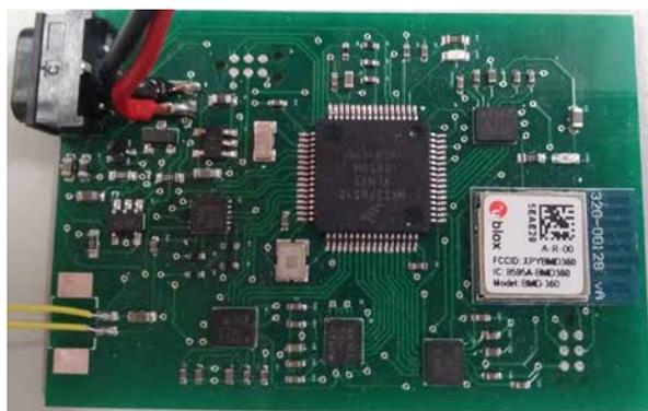
Abb. 2 Das fertig bestückte PCB mit vier 9D Sensoren
