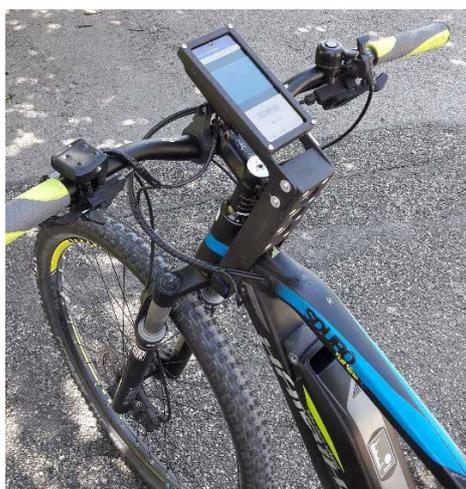
Abb. 1 Halterung für das Smartphone
