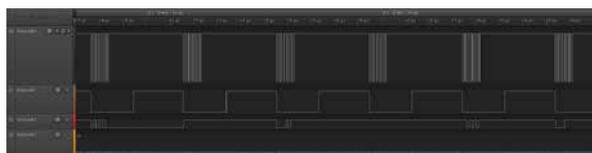
Abb. 3 In diesem Bild ist ein Test mit dem Logic Analyzer zu sehen. Bei diesem Test wurden die Beschleunigungswerte der Sensoren über den SPI-Bus zum MC gesendet. Channel 0: Clock, Channel 1: MOSI, Channel 2: MISO
