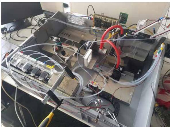
Abb. 1 Nachbildung des Fluidsystems des Analysegeräts an einem Testaufbau
