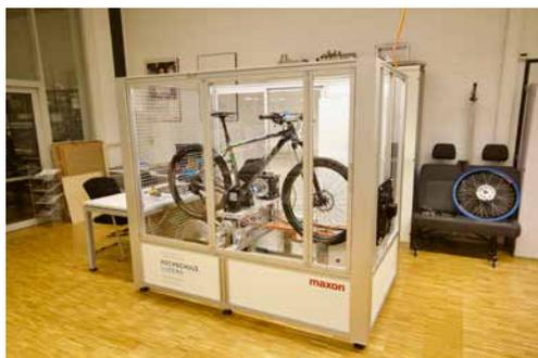
Abb. 1 E-Bike Prüfstand im Kompetenzzentrum Intelligent Sensors and Networks
