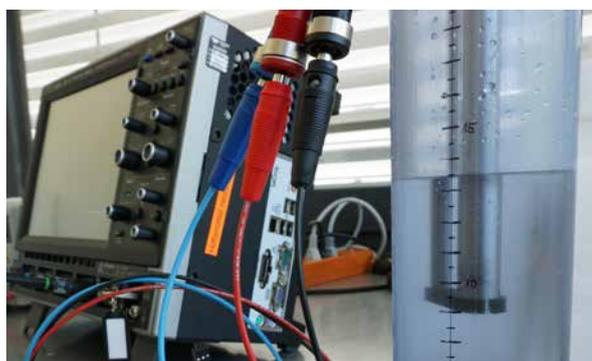
Abb. 3 Messaufbau für die Erfassung des Füllstandes
