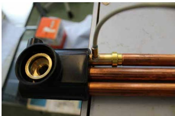
Abb. 3 Problematische Messinghalterung für Temperatursensor
