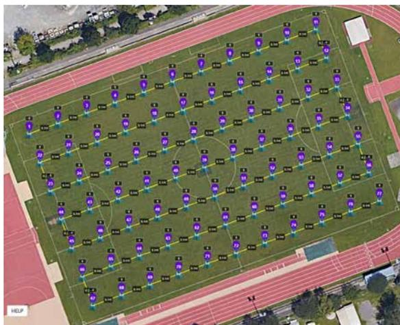
Abb. 2 Generierte Mission mit allen 77 Messpunkten
