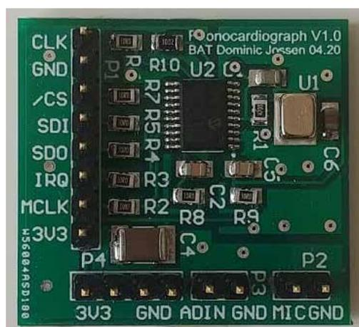
Abb. 3 Phonokardiograph PCB mit erweitertem Frequenzbereich bis 6Hz
