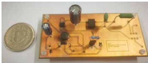
Abb. 3 Prototyp der Schaltung im Vergleich zu einem Fünffranken Geldstück, welches der ungefähren Endgrösse der Schaltung entspricht.
