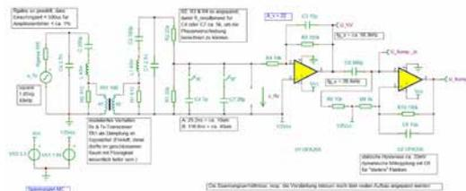
Abb. 2 Simulation der Ultraschallsensoren
