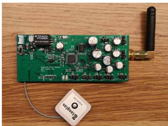
Abb. 1 Funkfernsteuerungsempfänger – Hardware
