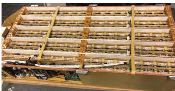
Abb. 2 Akkuzellen mit AMS PCB's
