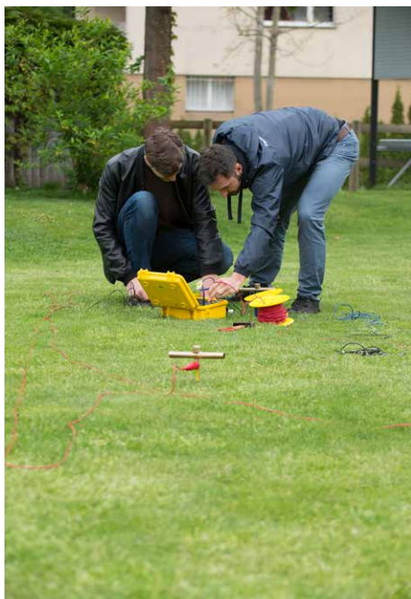
Mittels Erdsonden messen die Studierenden in einem Praxisversuch die Leitfähigkeit des Erdreichs.
