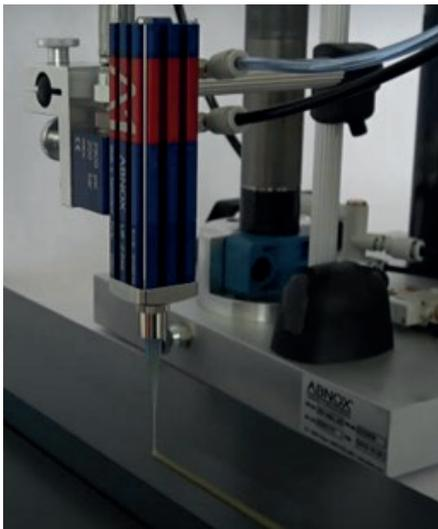
Abb. 1: Schmierstoffdosierung mit zeitgesteuertem Ventil
