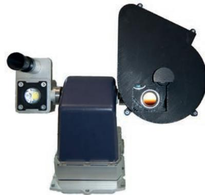
Abb. 2: Kameramodul mit montiertem Filtrerrad
