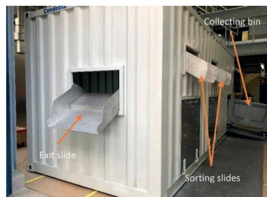
Abb. 3: Umgebauter ISO 20-Fuss Lagercontainer
