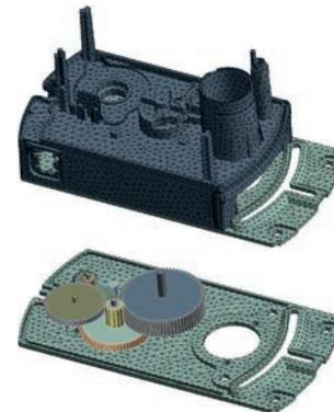
Abb. 2: Simulationsmodell oben mit und unten ohne Getriebegehäuse
