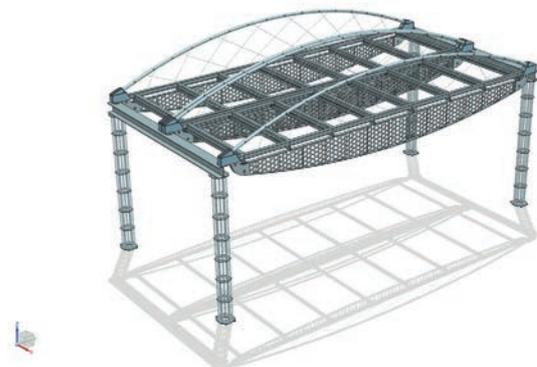
Abb. 3: Ergebnis Neukonzept der Tragwerksstruktur
