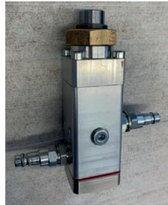
Abb. 2: Optimierter Materialdruckregler-Prototyp
