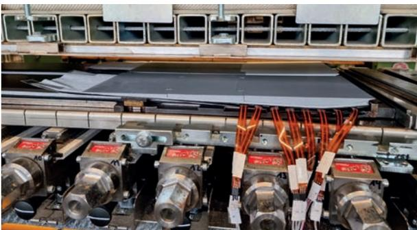
Abb. 2: Messsystem mit 3D-Druck Prototyp des Keiles in der geöffneten Presse
