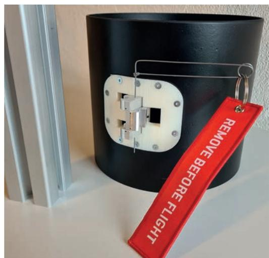
Abb. 3: Prototyp der einfahrbaren Launch Lugs
