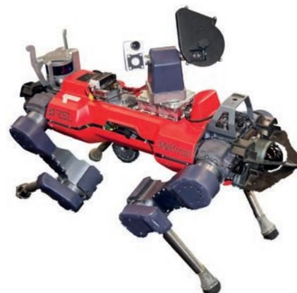
Abb. 3: Roboter mit Filtrerrad
