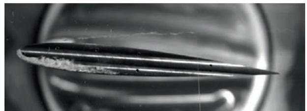
**Abb. 3:** Strömungsrichtung von links nach rechts, Bild aus Hochgeschwindigkeitsvideo mit Wirbelkavitation an der Ober- und Spaltkavitation an der Unterkante,  $\alpha = 4^\circ$ ,  $\sigma = 1.55$ ,  $s = 1.0$  mm
